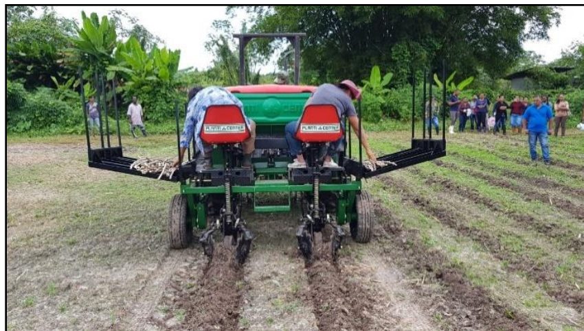
Figuur 24. Twee – rijen cassave plantmachines.
